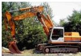
Macchina operatrice semovente su cingoli o ruote gommate, spinta da un motore endotermico diesel e dotata di un braccio articolato alla cui estremità viene montata una benna.
