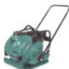
Il compattatore a piatto vibrante è una macchina destinata al costipamento di rinterri di non eccessiva entità, come quelli eseguiti successivamente a scavi per posa di sottoservizi, ecc.
