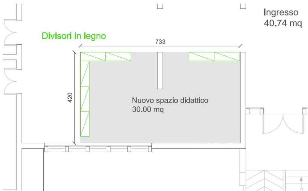
Particolare della disposizione delle pareti attrezzate per la delimitazione dello spazio
