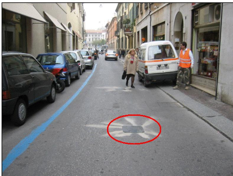
**Rilievo dei flussi veicolari: posizionamento dell'apparecchio**
